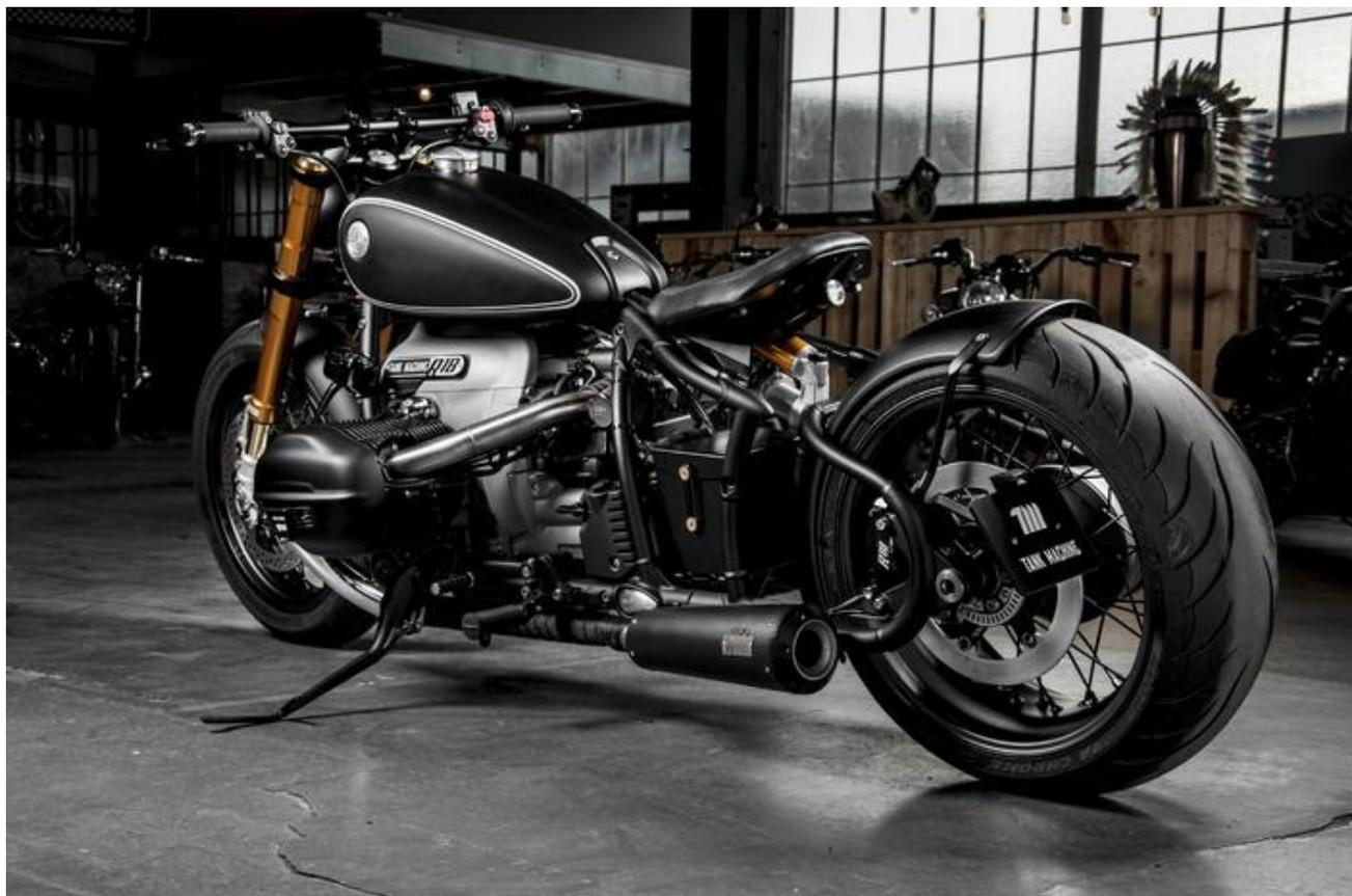
Cela commence les roues : les jantes de 19" (avant) et 16" (arrière) sont remplacées par des jantes rayonnées sur mesure de 18". Elles se chaussent de pneumatiques Avon Cobra Chrome à l'avant légèrement plus large (130/70R18 contre 120/70R19 ) et à l'arrière nettement enflé (240/40 R18 contre 180/65R16).
