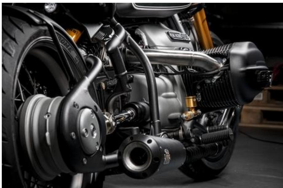
Au niveau moteur, pas de modifications mais la boîte à air disparaît au profit de cornets K&N et les conduits d'admission sont réalisés sur mesure. Une ligne d'échappement Dr Jekyll & Mr Hyde qui se caractérise par des valves commandées par un système électrique bridant le bruit ou libérant complètement les gaz est adapté à la moto. La commande est située sur la gauche du carter principal, à portée de main.
