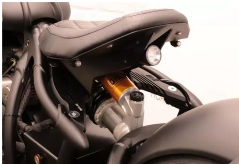
Pièce unique créée pour la selle, le feu et l'amortisseur Ohlins
