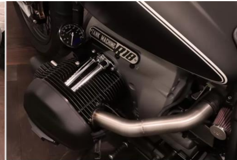
Seules les tiges de culbuteurs restent chromées, le moteur est inchangé
